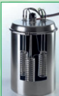
Dans le cylindre en acier inoxydable de hautes caractéristiques, entre 1 et 5 éléments de chauffage haute qualité chauffent l'eau selon le principe de la chaudière à immersion. L'interrupteur à flotteur et le capteur de température fonctionnent ensemble pour contrôler le niveau de l'eau et éviter un fonctionnement à sec.
